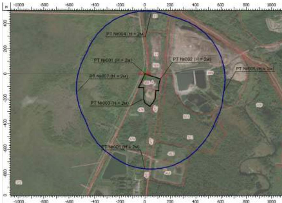
Рисунок 4 - Расположение точек, принятых для проведения расчетов рассеивания выбросов загрязняющих веществ от объекта рекультивации
