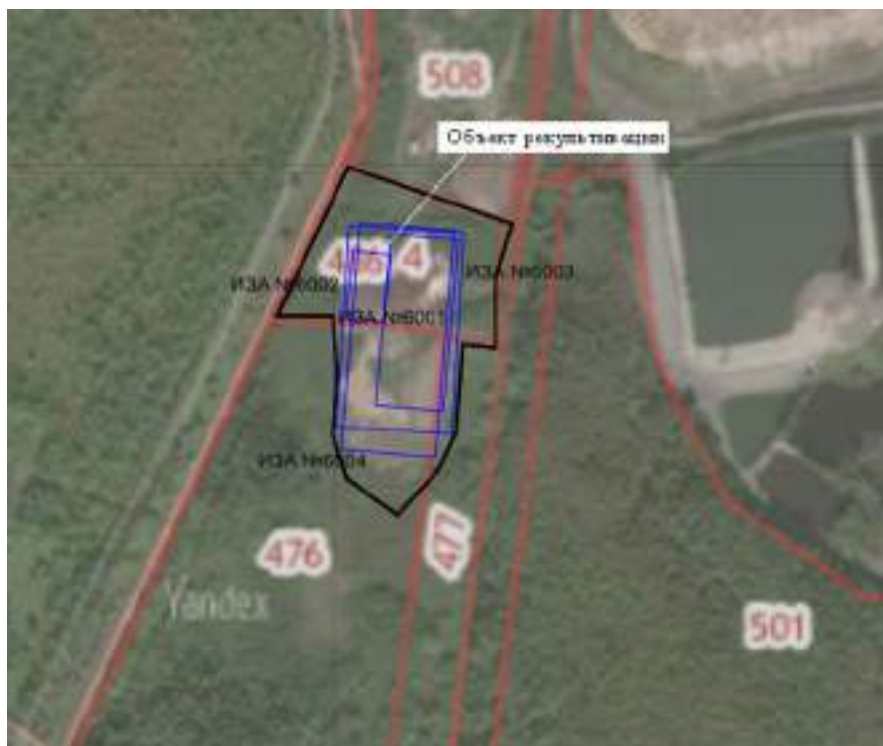
Рисунок 3 - Объект рекультивации и расположение ИЗА №№6001-6004
